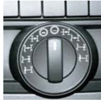
Переключатель дифференциала полного привода.
