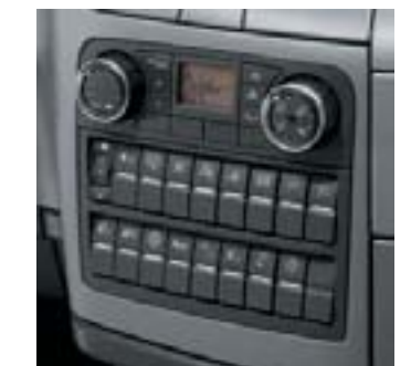
Новые элементы управления климатической установкой. Обогрев и вентиляция. Новые панели выключателей с функциональной индикацией.
