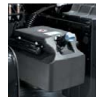
Отдельный бак AdBlue® для строительных автомобилей.
