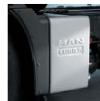
Глушитель с катализатором SCR для выполнения Евро 5.
