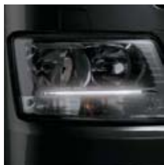
Фары с рефлекторами свободных форм. Ксеноновые огни ближнего света. Светодиодные стояночные огни.
