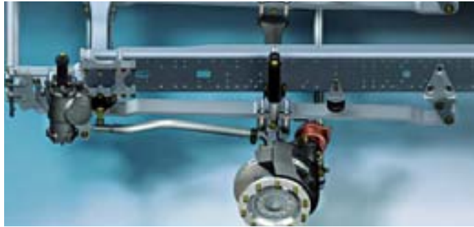
Однолистовая рессора способствует снижению собственного веса автомобиля.
