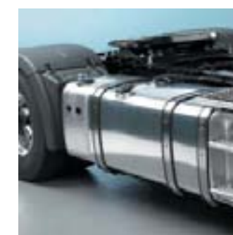
Комбинированный бак для дизеля и AdBlue®.
